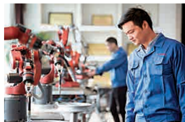
▲浙江溫州企業技術人員在調試自主研發的6關節小型機器人 資料圖片
