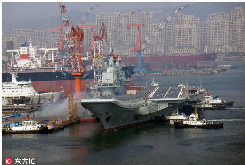
可以看见辽宁舰右舷舰载机停放区的边线从红色变成了黄色，以方便和着舰区颜色相区隔
