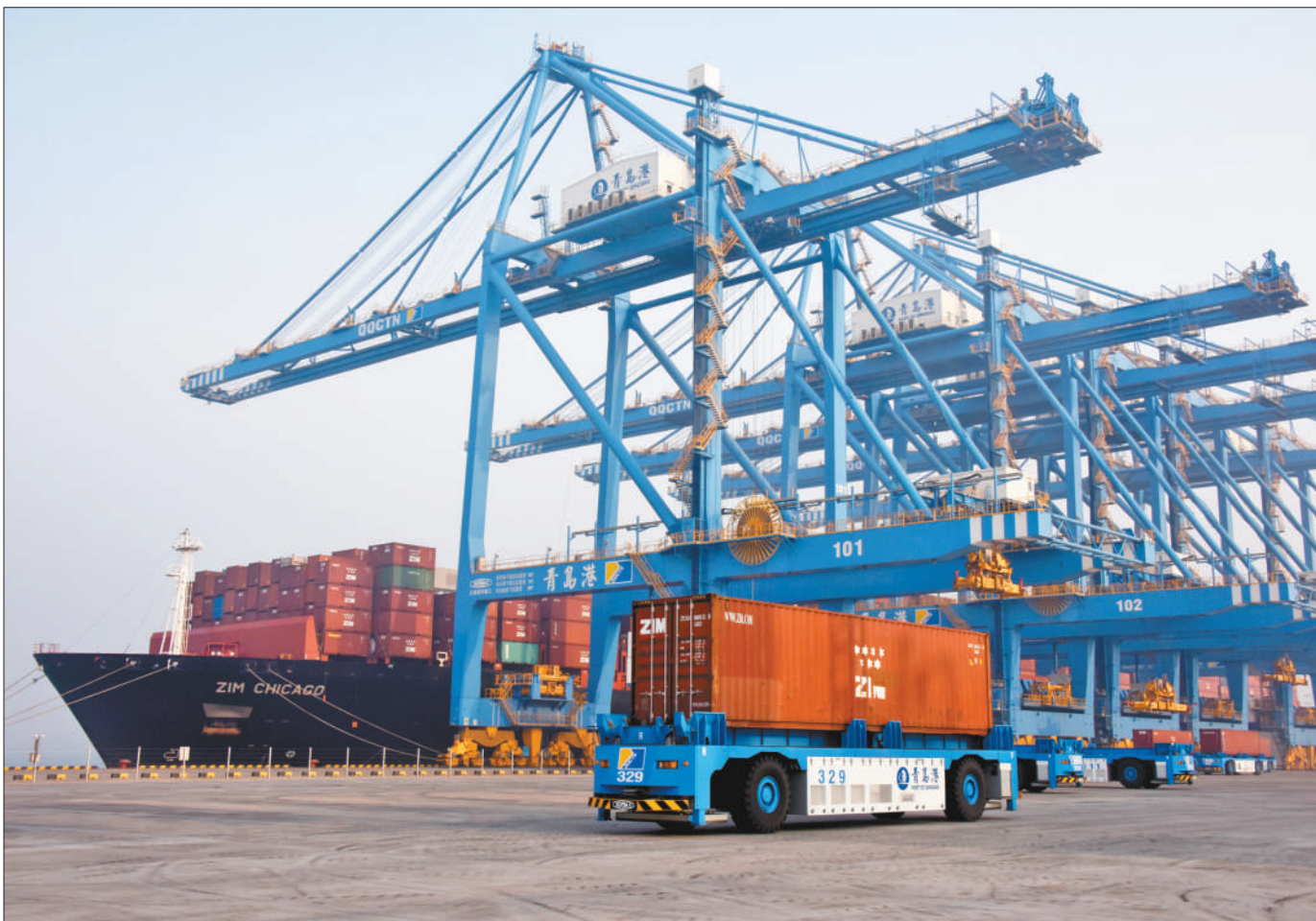
12月3日，“以星芝加哥”集装箱船作业中，青岛港全自动化集装箱码头的单机平均作业效率达到39.6自然箱/小时，创下全球自动化码头单机平均作业效率最高纪录，且全面超越人工码头作业效率，比全球自动化码头单机平均效率高出50%。图为“以星芝加哥”轮船在青岛港全自动化码头装卸集装箱。
